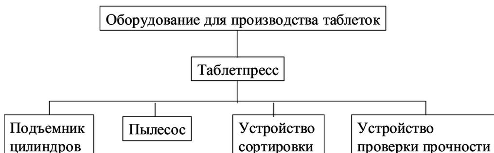
**Подъемник цилиндров** работает с фиксированной скоростью, которая регулируется кнопками для подъема и опускания. Подъемник цилиндра переносит цилиндр, наполненный продуктом из исходной стационарной позиции к воронке бункера над производственным оборудованием. Доставка осуществляется на разные уровни без вмешательства человека. Транспортировку можно проводить по направлению вверх, вниз вперед, назад и поворот.
